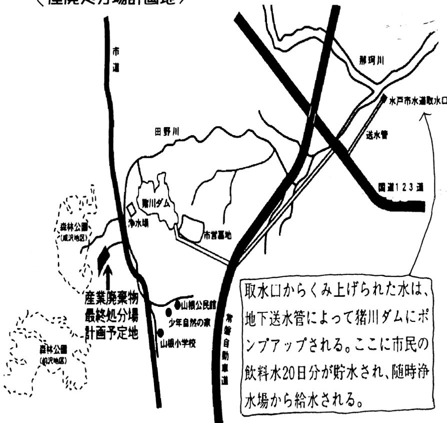
取水口からくみ上げられた水は、地下送水管によって猪川ダムにポンプアップされる。ここに市民の飲料水20日分が貯水され、随時浄水場から給水される。
